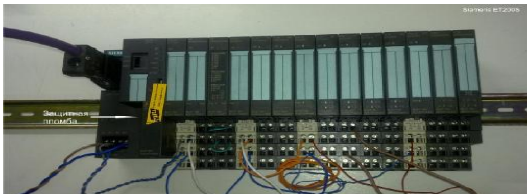
Рисунок 3. Схема пломбирования контроллера «SIMATICET200
