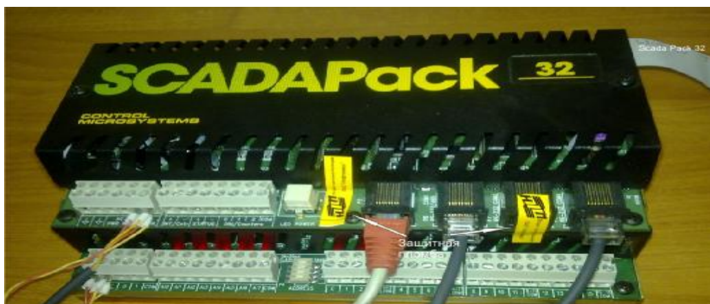
Рисунок 4. Схема пломбирования контроллера «SCADAPack32».
