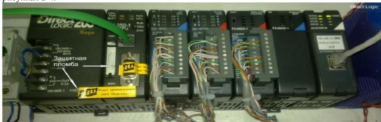
Рисунок 2 - Схема пломбирования контроллера «Direct Logic»
