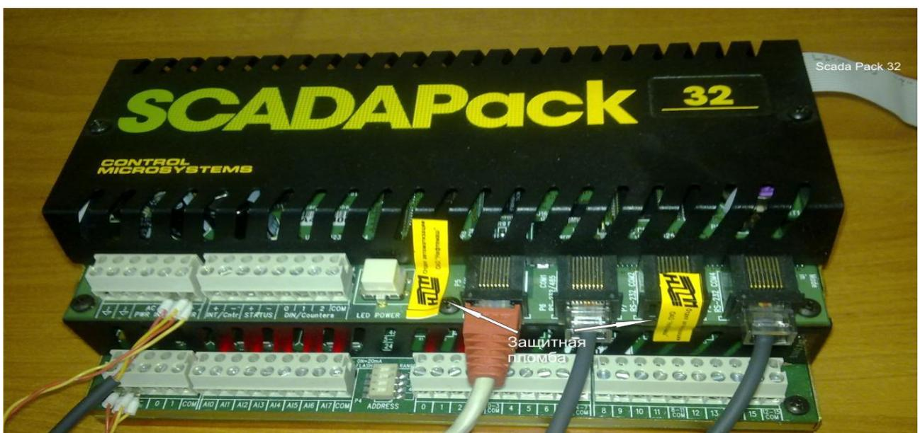
Рисунок 4 - Схема пломбирования контроллера «SCADAPack32»
