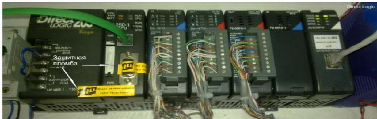
Рисунок 2 - Схема пломбирования контроллера «Direct Logic»
